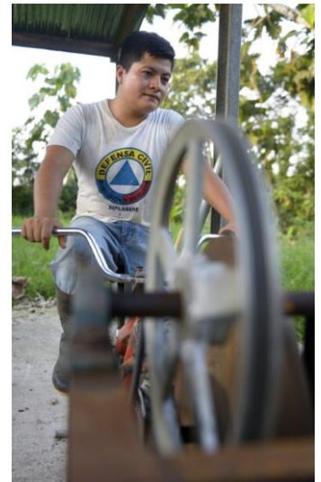
Genial einfach Ein kaputtes Fahrrad, ein Schwungrad, einige Eisenstangen, Riemen und Rollen – Jesús Placencias Fahrradmaschine ist ebenso simpel wie effektiv.
